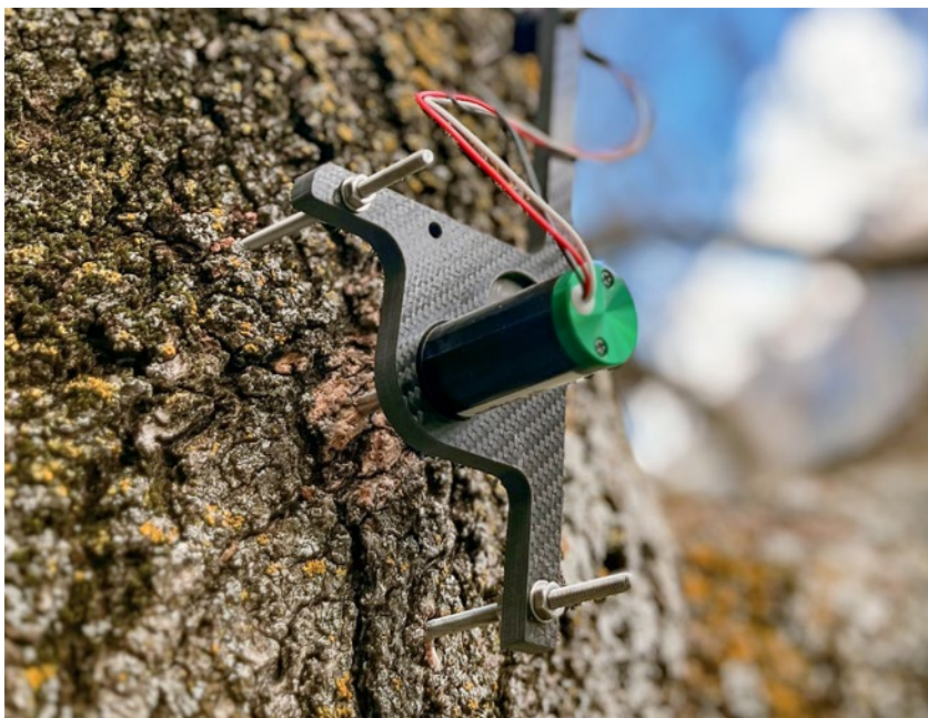
Abb 1 Punktdendrometer messen Radiusänderungen an Baumstämmen. Foto: Roman Zweifel
